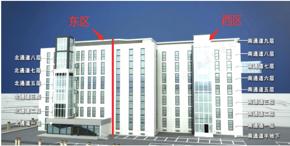
图 1 起火建筑结构示意图(北向南)
